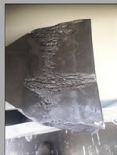
مشاهده الگو سایشی و شکست در بیرینگ (فقر روانکاری + آلودگی ذرات محیطی)
