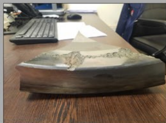
مشاهده الگو سایشی و شکست در بیرینگ (فقر روانکاری + آلودگی ذرات محیطی)
