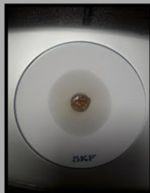
نتایج تست گریس در حالت اورگریس با دستگاه SKF
