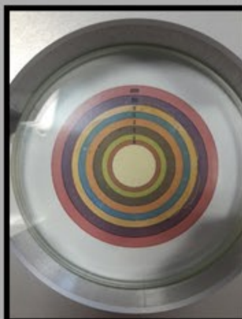
نتایج تست گریس در حالت اورگریس با دستگاه SKF
